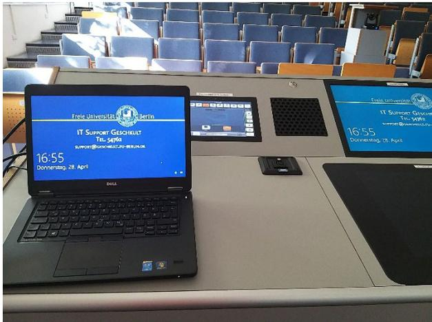
Medienpult mit Laptop an Anschluss HDMI und Bild auf Vorschaumonitor.
